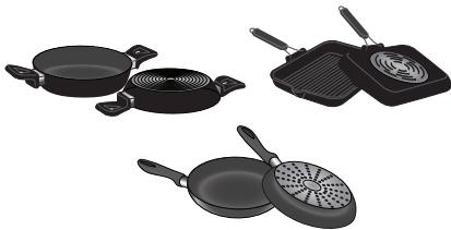
Brug altid gryder og pander med en flad bund, som fordeler varmen ensartet, for at sikre optimal effektivitet. Hvis bunden er ujævn, påvirker dette strøm- og varmefordelingen.
