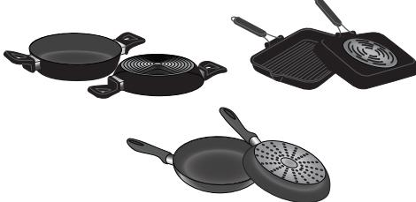
Для обеспечения максимальной эффективности всегда используйте кастрюли и сковороды с плоским дном, которое равномерно распределяет тепло. Если дно неровное, это повлияет на мощность и распределение тепла.
