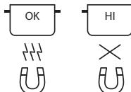
Слід застосовувати лише каструлі і сковороди, які виготовлено з феромагнітного матеріалу, що призначенні для використання з індукційними варильними панелями:
